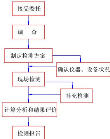
3.2.1 建筑结构检测工作程序框图
