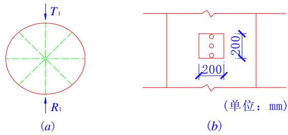
图 J.0.5 钢管中混凝土强度检测示意图
